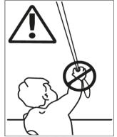
Für eine kindersichere Rollo Montage mit Schnur- und Kettenzuggetrieben ist ein Mindestabstand von 150cm (Boden bis untere Länge der Bedienelemente) zu beachten. Bei Nicht-Einhaltung der empf. Abstände ist die Kindersicherheit nicht gewährleistet.
